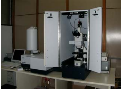
Fig. 5: Equipamento Raman interferométrico.
