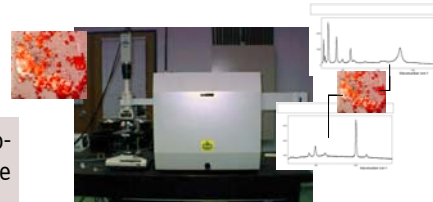
Fig. 4: Equipamento Raman dispersivo.
